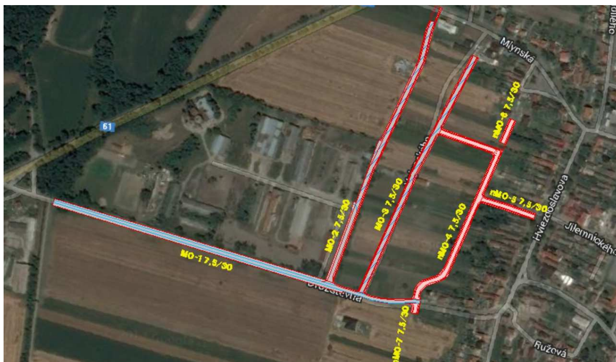
Navrhovaná sieť miestnych obslužných komunikácií s napojením na existujúce komunikácie (zdroj: https://www.google.sk/maps/ )
