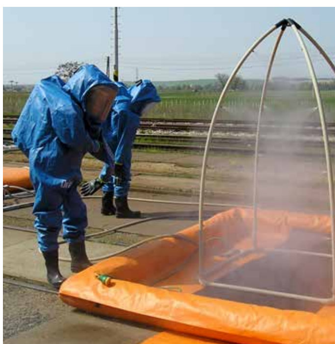
Obr. 6 Dekontaminačná sprcha DEKONTA
