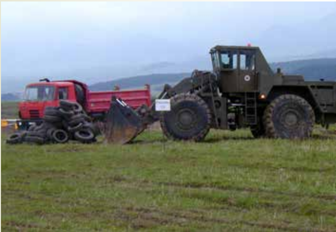
Obr. 8 Návčik budovania mrchovišťa kolesovým nakladačom KN 251 a T 815 UDS-214
