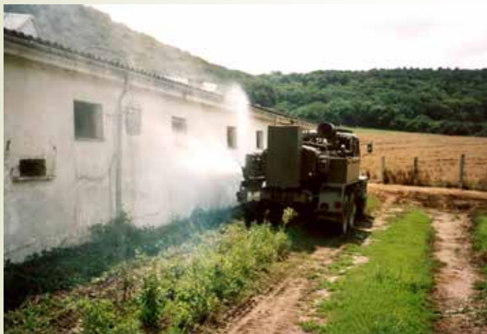
Obr. 3 Chemický rozstrekovací automobil PV3S/ARS – 12 M pri dekontaminácii v teréne
