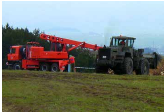
Obr. 8 Návčik budovania mrchovišťa kolesovým nakladačom KN 251 a T 815 UDS-214
