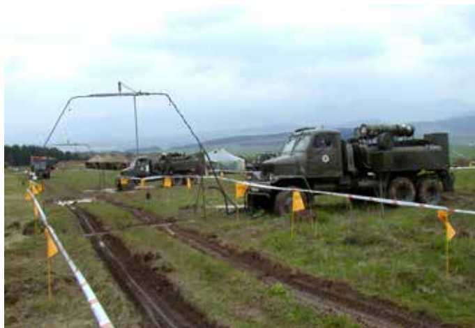
Obr. 3 Chemický rozstrekovací automobil PV3S/ARS – 12 M pri dekontaminácii v teréne
