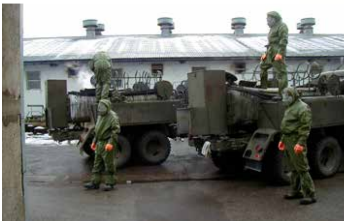
Obr. 5 Dezinfekcia maštalných priestorov pomocou PV3S ARS-12M
